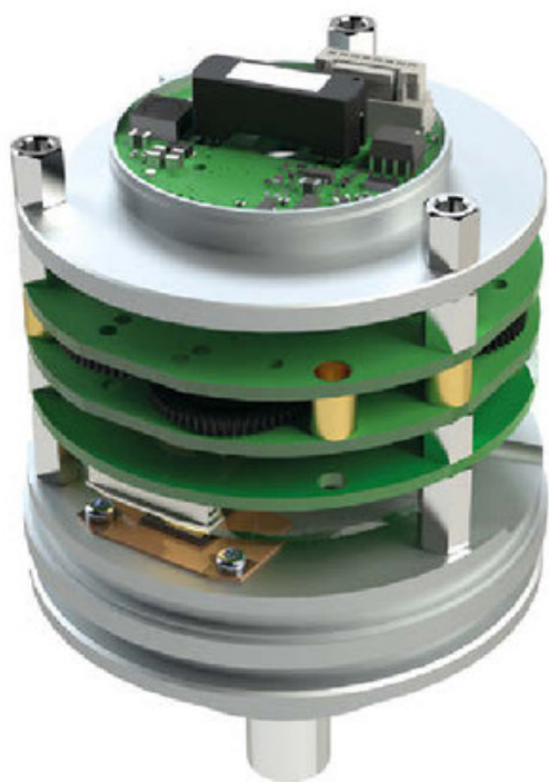
03 Magnetik (oben) und Optik (Mitte – in grün) ergänzen sich als Messsysteme in den neuen Encodern für sicherheitskritische Einsätze
